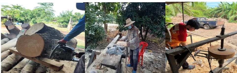
ภาพที่ 1 ขั้นตอนในการเลื่อยไม้มะขาม และขัดหน้าไม้ให้มีความเรียบ
