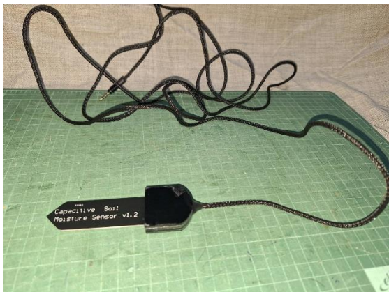
ภาพที่ 6 เซนเซอร์วัดความชื้นในดินแบบคาปาซิทีฟแบบอะนาล็อก
