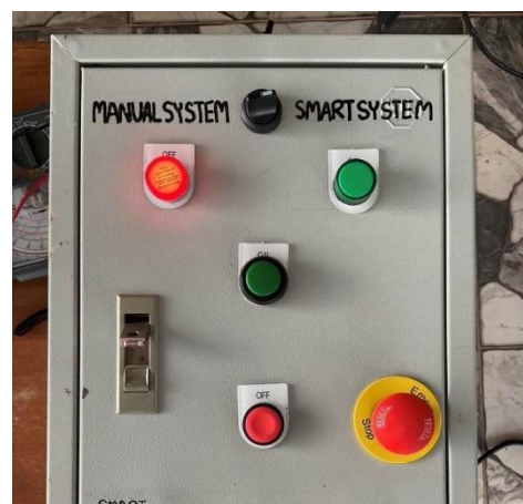
ภาพที่ 15 ไฟสถานะเมื่อปรับสวิตช์ลูกศรไปทาง Smart System
