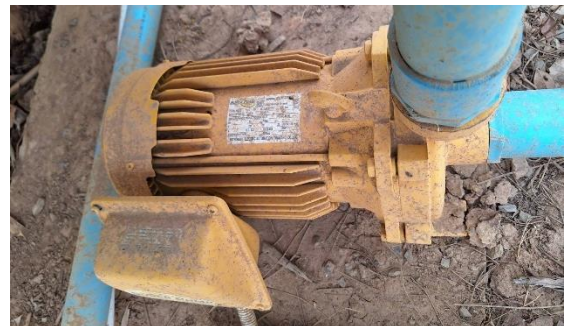
ภาพที่ 2 ปั้มน้ำหอยโข่งที่ใช้งานภายในแปลง
