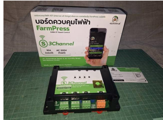
ภาพที่ 4 บอร์ดควบคุมไฟฟ้า
