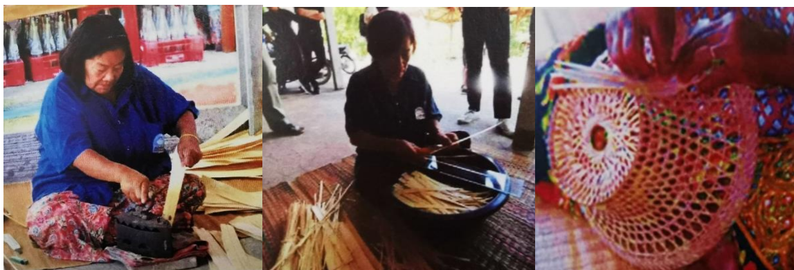
ภาพที่ 4 การรีดใบลาน การเจียนใบลาน และการกรูใบลานติดกับโครงงอบ
