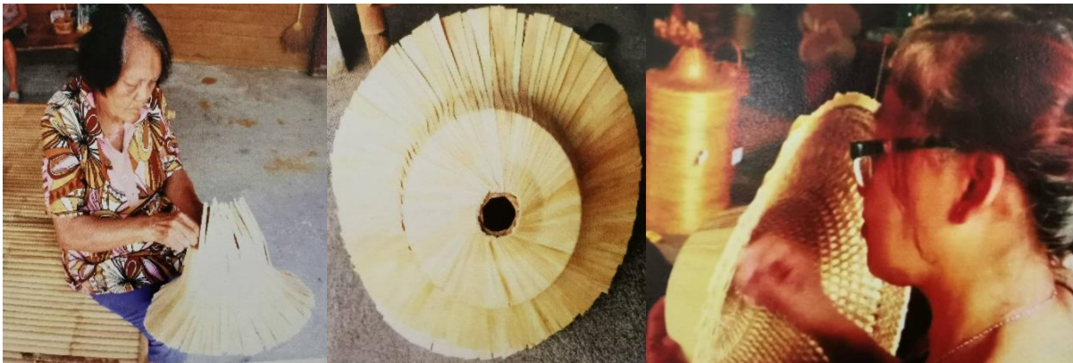
ภาพที่ 5 การล้มห่วงอบ การสักห้วงอบ และการเย็บใบลานติดกับโครงงอบ
