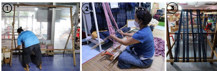
ภาพที่ 3 กระบวนการทอผ้ามัดหมี่ย้อมครามลายนาคน้อย 1) คั่นเส้นยืน 2) สืบทอด 3) ก๊อผ้า
