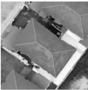
ภาพที่ 17 ตัวอย่าง Feature Extraction โดย Parameter Orientation = 5, Pixel per Cell = (5,5), Cell per Block = (2,2)
