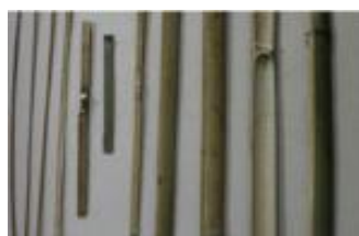
ภาพที่ 6 : การแยกขนาดไม้ไผ่ ภาพที่ 7 : การเหลาไม้ไผ่เพื่อตัดทำโครงสร้าง
