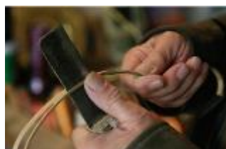
ภาพที่ 6 : การแยกขนาดไม้ไผ่ ภาพที่ 7 : การเหลาไม้ไผ่เพื่อตัดทำโครงสร้าง
